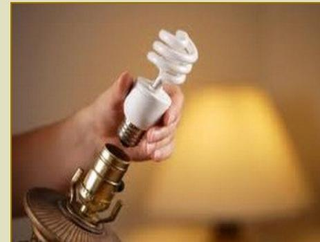
باید هنگام تعویض لامپ فلورسنت فشرده دقت نمود که حتی الامکان از تماس دست با قسمت شیشه ای جلوگیری کرد . استفاده از لامپ های با کیفیت بالا و معتبر خطر شکستن را در آن کمتر می کند
